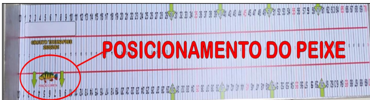
Figura 1 – MODELO DE RÉGUA DE MEDIÇÃO – RÉGUA RÍGIDA – ALUMÍNIO ADESIVADA
